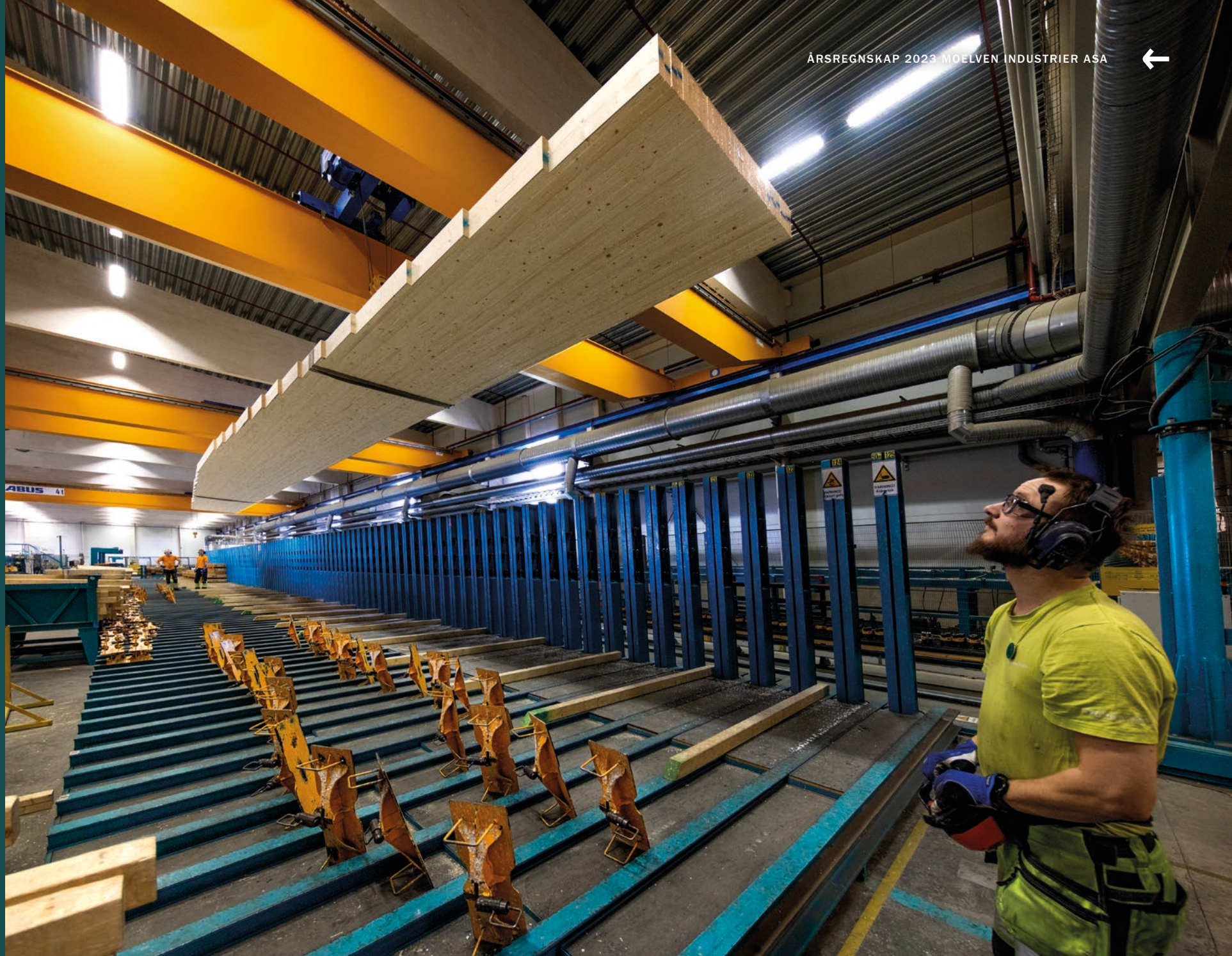
Elgigantens nye lager- og logistikkbygg i Jönköping blir et av Nordens største. Moelvns leveranse består av over 500 saltaksbjelker, og de er 24 meter lange og nesten to meter høye. Den bærende konstruksjonen i det 86 000 kvadratmeter store bygget består i sin helhet av limtre fra Moelven Töreboda AB og Moelven Limtre AS. Foto: Sören Håkanlind og Jonas Ingman
