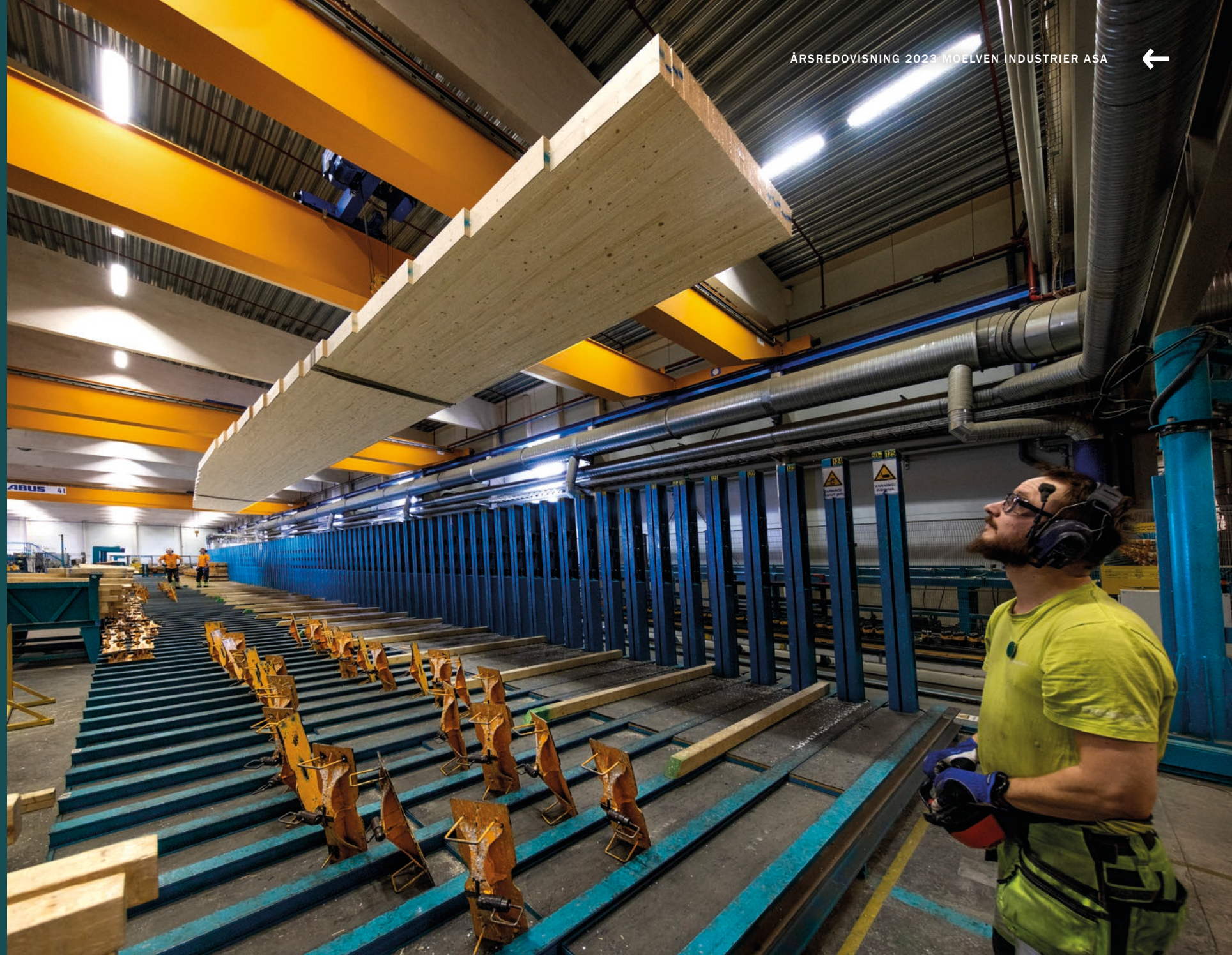
Elgigantens nya lager- och logistikanläggning i Jönköping blir en av de största i Norden. Moelven tillhandahåller över 500 sadeltaksbjälkar, vilka är 24 meter långa och nästan två meter höga. Den bärande konstruktionen i den 86 000 kvadratmeter stora byggnaden består enbart av limträ från Moelven Töreboda AB och Moelven Limtre AS. Foto: Sören Håkanlind och Jonas Ingman
